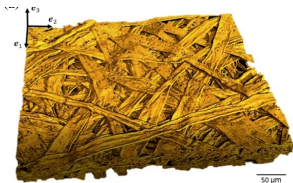
Vue 3D d'un papier obtenue par micro tomographie à rayons X (Orgéas et al. Cellulose, 2021).
